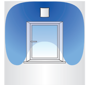
Schemat dystrybucji powietrza w zależności od stopnia regulacji
